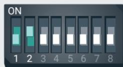
Abb. 18 Kippschalterpositionen für Lastmanagement Light
