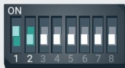
Abb. 21 Kippschalterpositionen für Lastmanagement PWM
