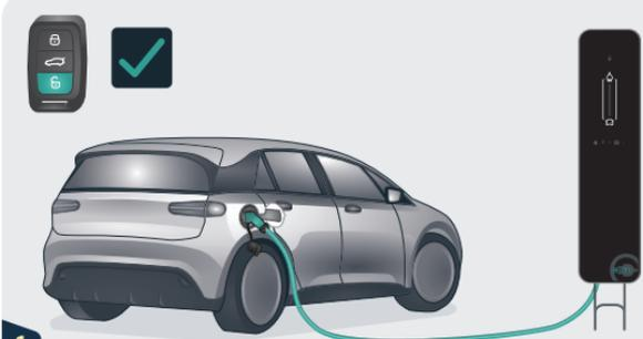
Ladung am Fahrzeug beenden und Ladekabel freigeben (Meistens durch Öffnen des Fahrzeugs mit dem Fahrzeugschlüssel).
