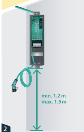
Entfernen Sie die Ladestation und bohren Sie an der angezeichneten Bohrstelle mit einem 8 mm Bohrer ein Loch. Stecken Sie den mitgelieferten Dübel in das Loch und drehen Sie die mitgelieferte 5 mm Schraube bis zu einem Abstand von 5 mm ins Loch.
