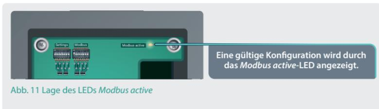
Abb. 11 Lage des LEDs *Modbus active*
