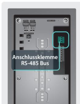
Abb. 23 Position der Anschlussklemme des RS-485 Busses
