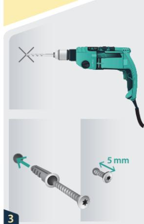
Hängen Sie nun die Ladestation an die Schraube. Zeichnen Sie die Bohrung im unteren Bereich des Gehäuses an.
